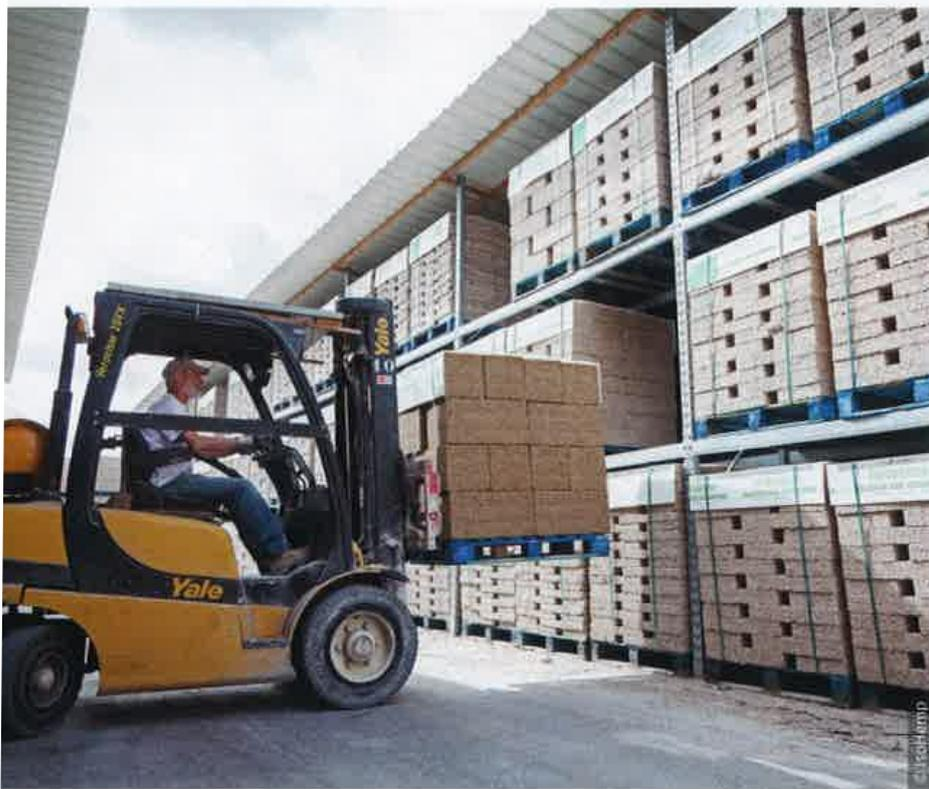
Les blocs de chaux-chanvre sont légers et faciles à mettre en œuvre. Ils se prêtent tant à la construction de cloisons intérieures qu'au remplissage d'une ossature ou au doublage d'un mur existant.
