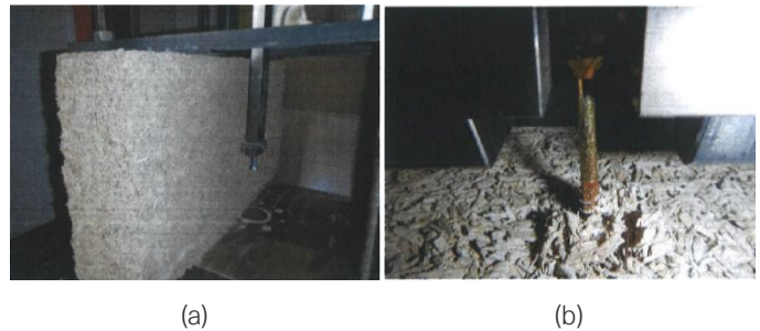
Abbildung 2 – Prüfanordnung - Quer- (a) und Axialwiderstand (b) der Befestigungen in einem ISOHEMP-Hanfstein
