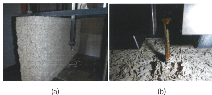
Fig. 2 – Proefopstelling – transversale (a) en axiale (b) treksterkte van bevestigingen in ISOHEMP hennepblok
