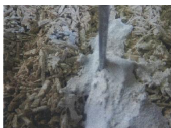
Fig. 3 – Proefopstelling – trek- en druksterkte van bevestigingen in lijmmortelvoeg tussen twee ISOHEMP hennepblokken
