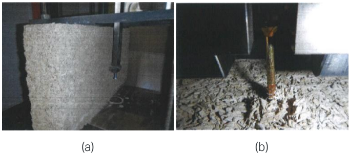
Fig. 2 – Configuration d'essai - résistance transversale (a) et axiale (b) des fixations dans un bloc de chanvre ISOHEMP
